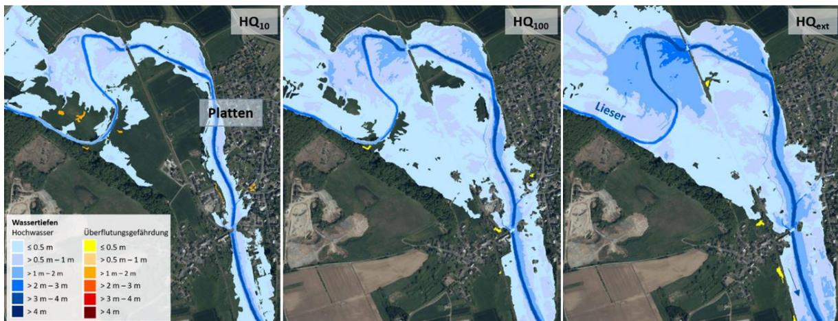
Abbildung 6: Hochwassergefahrenkarte Nims – Bereich innerhalb der Ortslage Birtlingen.
