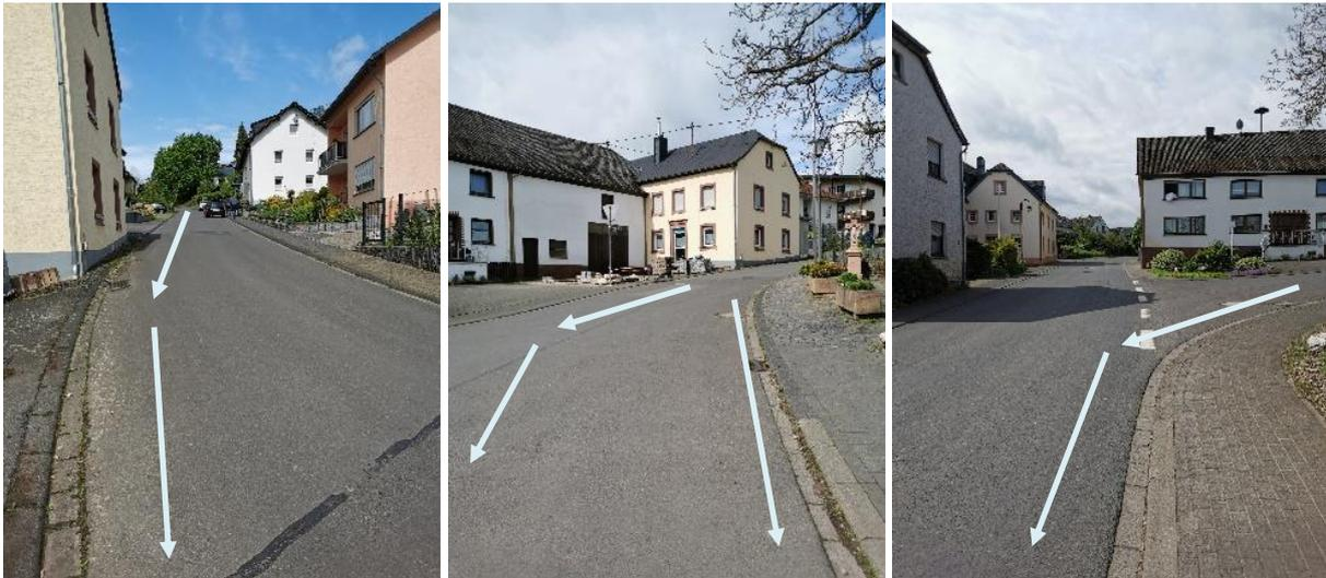
Abbildung 21: Darstellung der Fließwege von Oberflächenabfluss aus dem Außengebiet über die Bergstraße in Richtung Trierer Straße.
