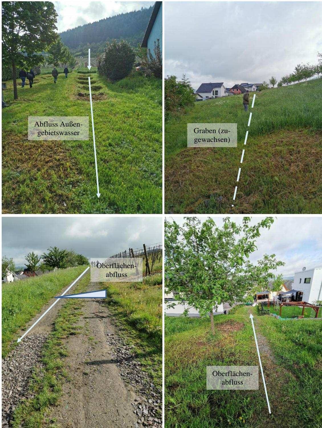
Abbildung 11: Darstellung der Fließwege von Oberflächenabfluss im Außengebiet oberhalb Unterm Wingert.
