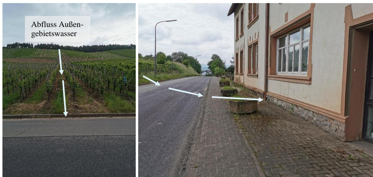
Abbildung 10: Darstellung der Fließwege von Oberflächenabfluss aus dem Außengebiet Wittlicher Straße, Hausnr. 27.
