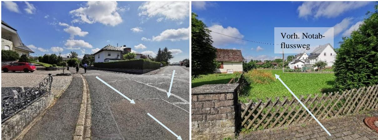
Abbildung 31: Fließwege von Oberflächenabfluss über Zum Mühlenberg, Kreuzungsbereich Jakob-Marx-Straße (links) und freizuhaltenen Abflusskorridor (Notabflussweg) zwischen Maarstraße Nr. 22 und Nr. 24 (rechts).
