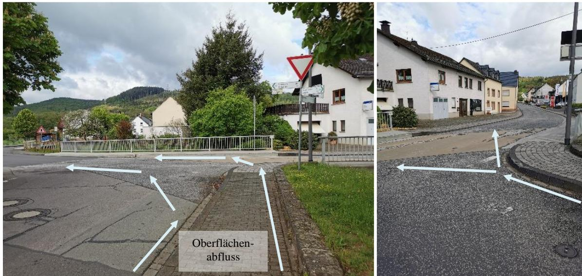
Abbildung 11: Kreuzung Talstraße/ Zum Burgberg, Darstellung der Fließwege von Oberflächenabfluss.
