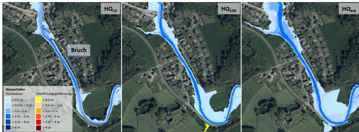
Abbildung 4: Hochwassergefahrenkarte Salm – Südlicher Bereich der Ortslage Bruch.
