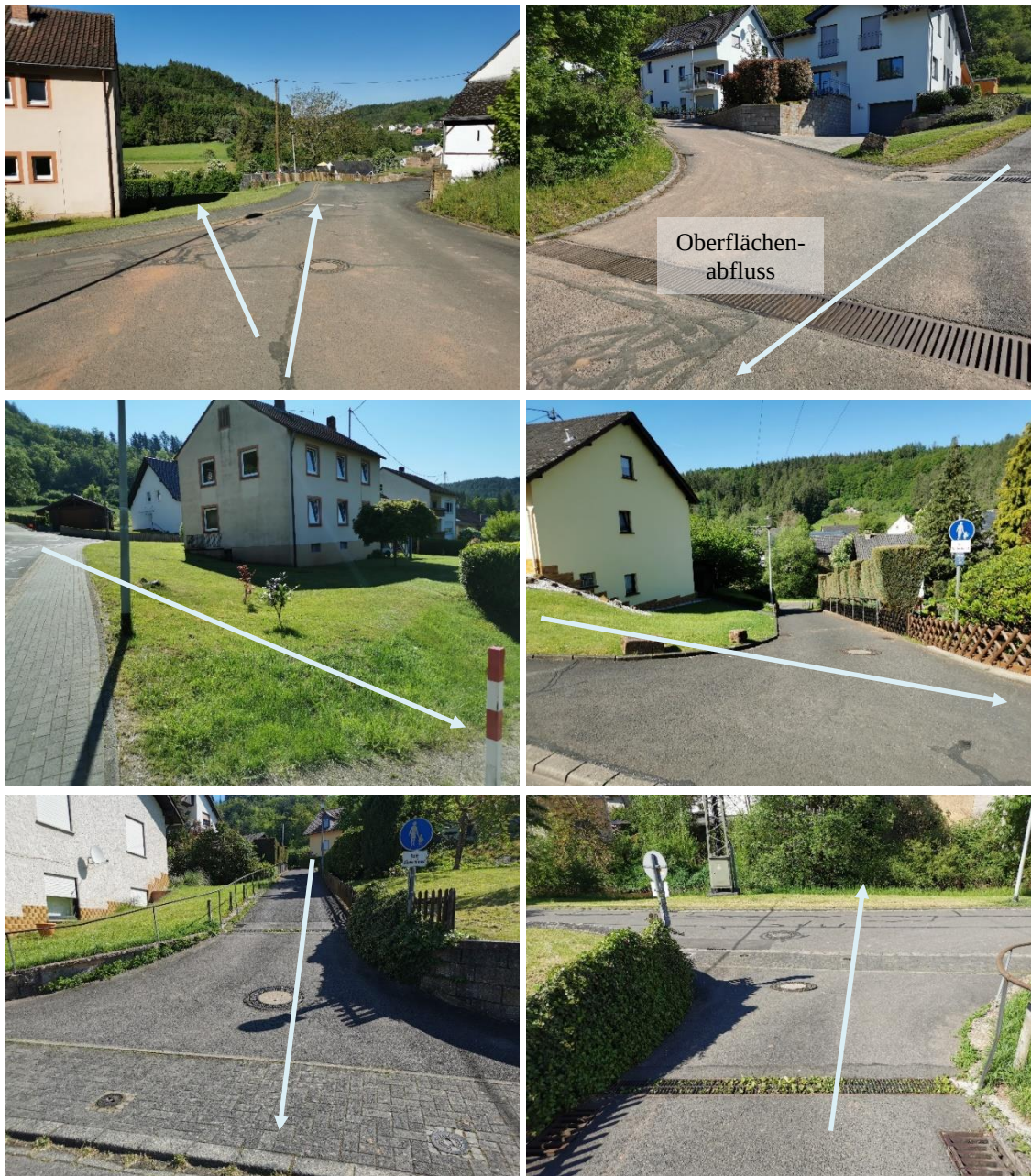
Abbildung 16: Oberflächenabfluss aus dem Außengebiet oberhalb von In der Huf und Darstellung der Abflusswege.
