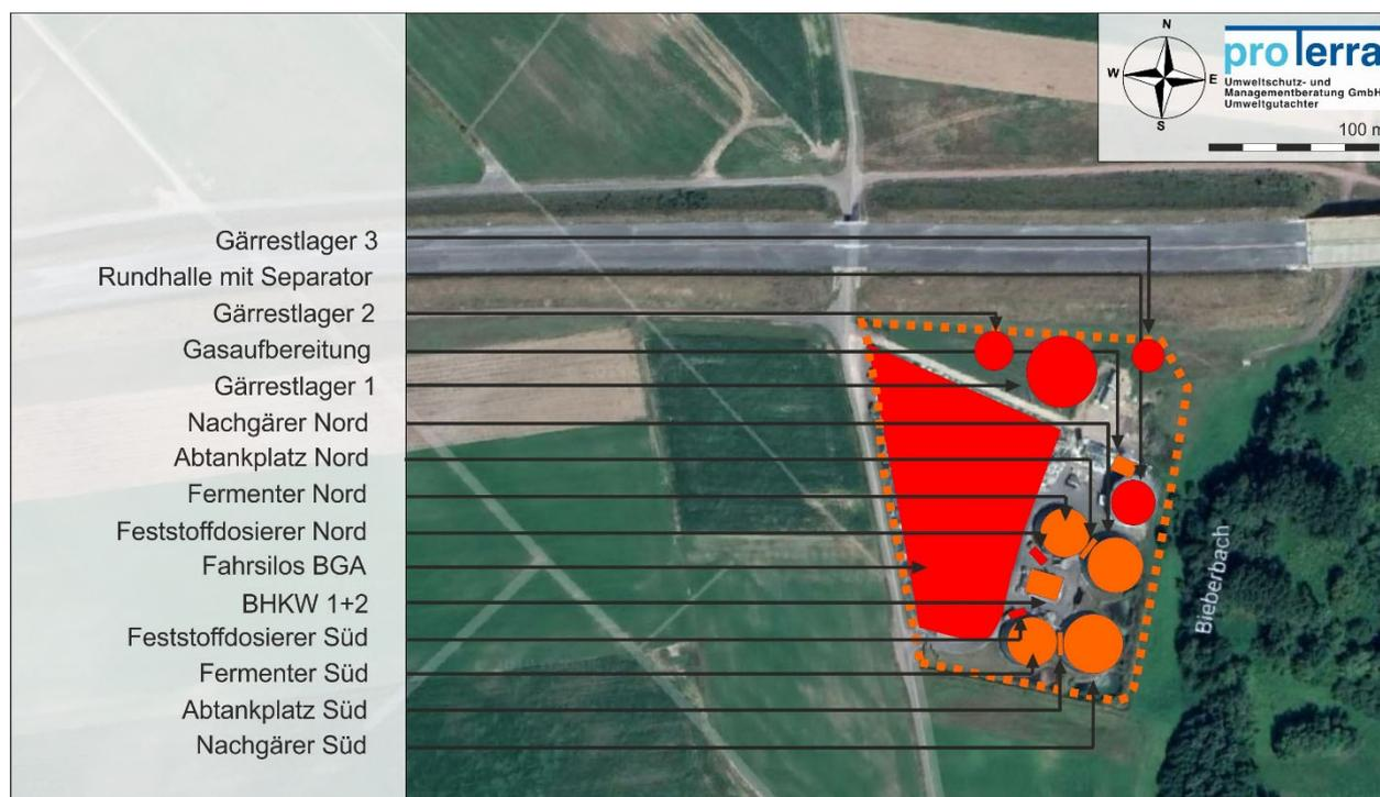
Abbildung 4-1: Lage der bestehenden (orange) und geplanten bzw. geänderten Betriebsteile (rot). Die Betriebsflächen der Biogasanlage Platten sind orange umrandet.
