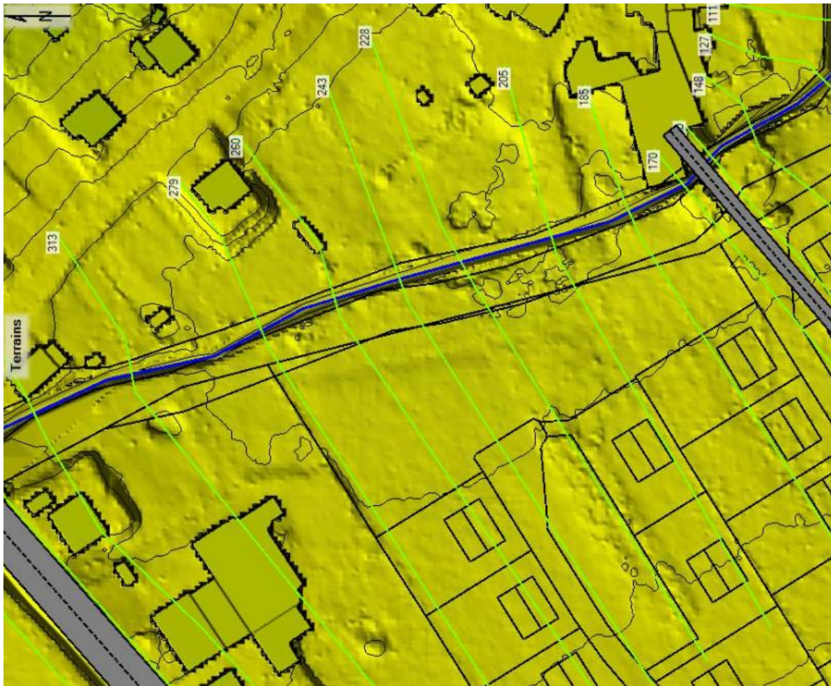
Abbildung 6: Profillageplan mit Geländemodell
