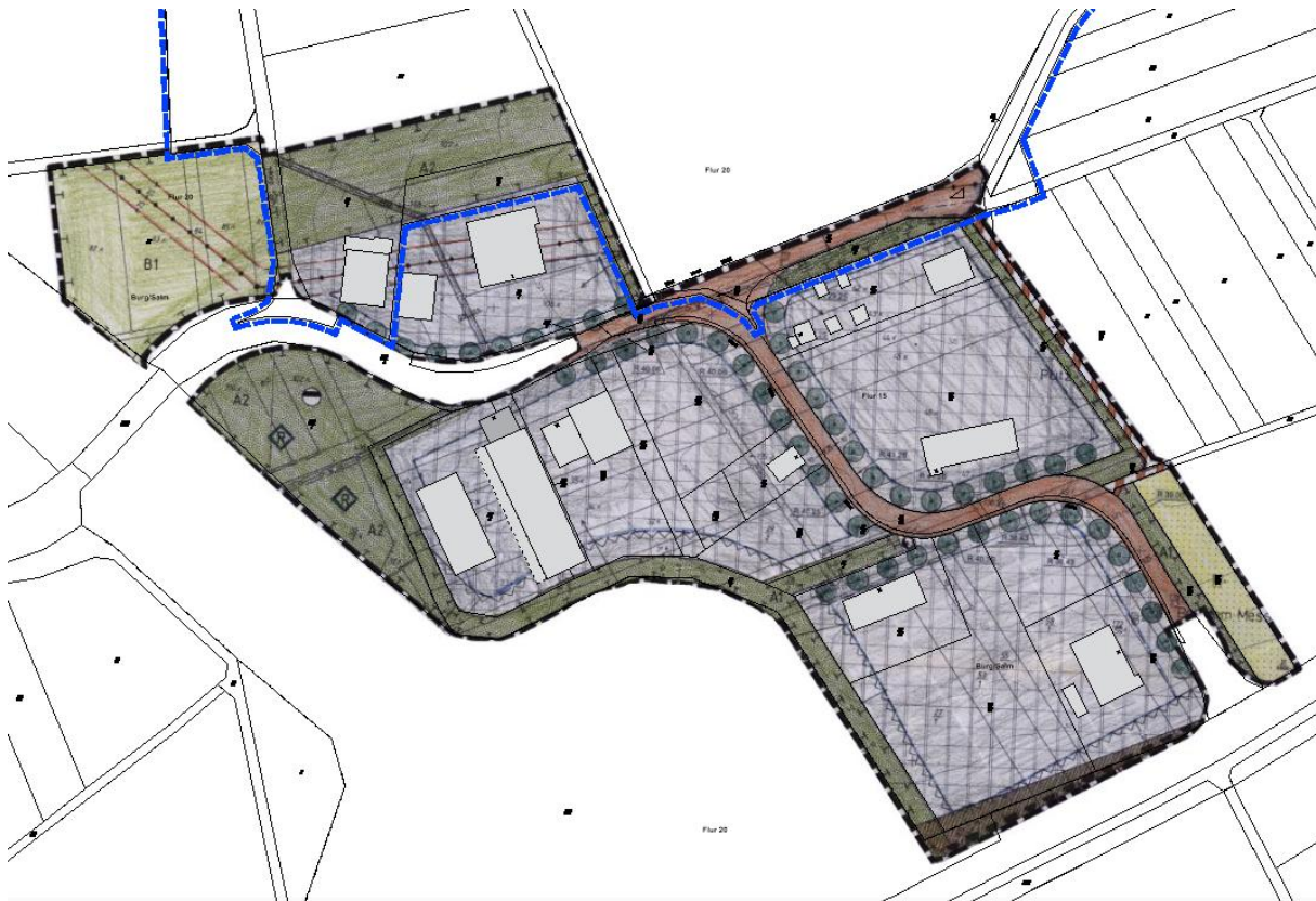
Abbildung 4 Bebauungsplan „Gewerbegebiet“ der Ortsgemeinde Landscheid (1999) mit Überlagerung Geltungsbereich Erweiterung (blau) (© Ortsgemeinde Landscheid / Verbandsgemeinde Wittlich-Land | eigene Darstellung)
