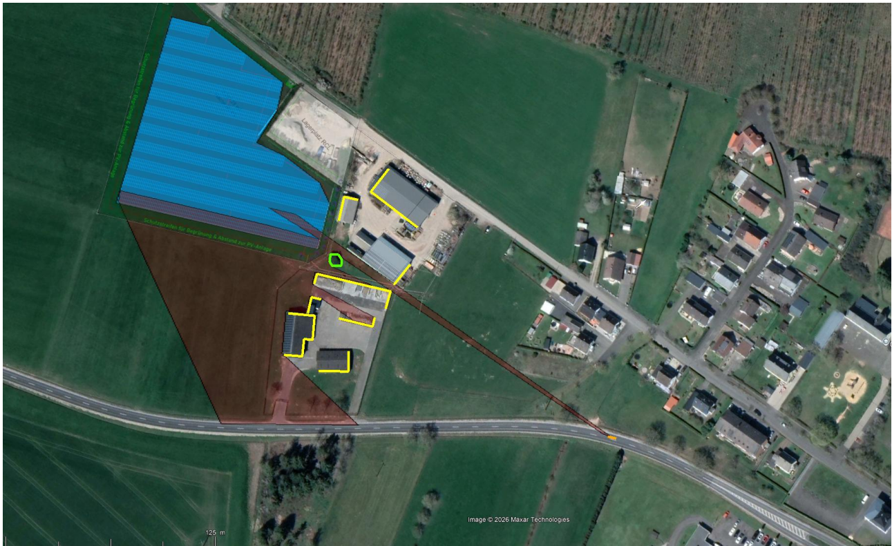
Abbildung 5: Betroffener Streckenabschnitt mit Reflexionen im relevanten Sichtfeld der Verkehrsteilnehmer in Orange, bestehende Strukturen in Gelb und Grün, mögliche Immissionen in Rot (Quelle: Google Earth, Maxar Technologies)
